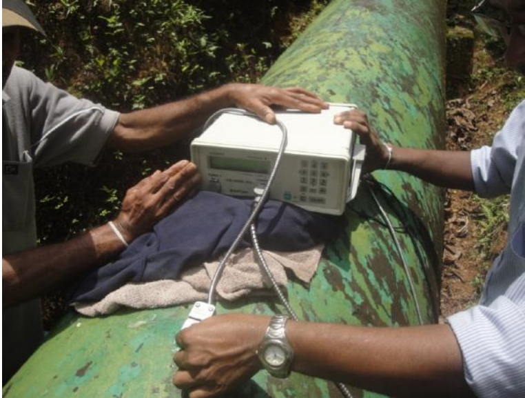
16 රූපය: කුඩා ජල වීදුලි බලාගාරයක කාර්ය සාධනය ඇගයීමේදී ගැලීම් මිනුම් ලබාගැනීම
