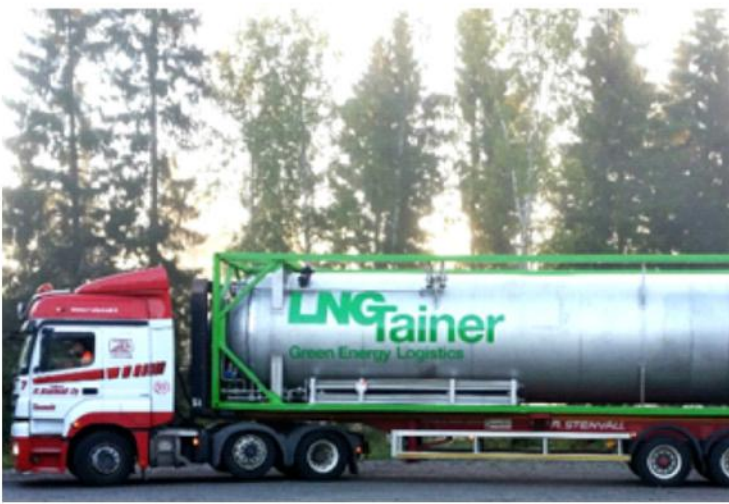
LNG transportation via LNG Road Container
